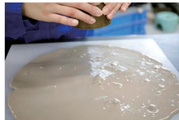
道路の埋め戻しに使われている、流動化処理土の流動性を調べる「フロウ試験」。流動化処理土に、再生石膏を加えることでより再掘削しやすくなる。
