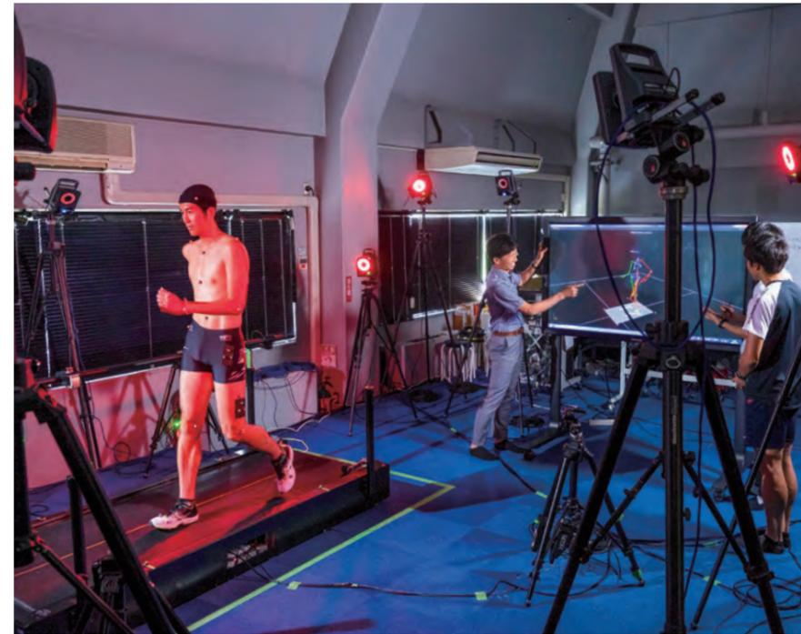
▲バイオメカニクス実験室には動作解析機器も完備。アスリートの全身に数十個のマーカーを装着し、複数台の赤外線カメラで動きを解析する。
