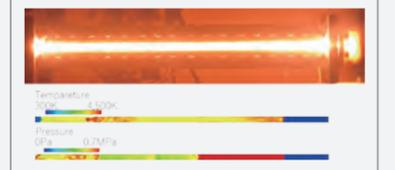
上図：可視化実験、中図：計算結果の温度、下図：計算結果の圧力。
