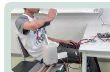
▲腕を上げ下げしようとする利用者の力を感知・計測し、その力に応じて制御を行いながら動作サポートを行う上腕動作支援装置。
