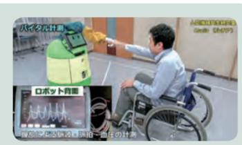
▲ロボットにはアーム型のバイタル計測装置に加え、顔部体温計測機能や歩行特徴の認識機能も設置。三枝准教授が豊橋技術科学大学に在籍した際の大学院生の研究がベースとなっている。
