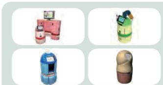
▲介護医療コンシェルジュロボットは、研究モデルの「Lucia(ルチア)」(上段)と普及モデル(下段)で区分して製作を進捗する。高さは110cm程度で自律的にステーションに戻って充電を行う仕組み。
