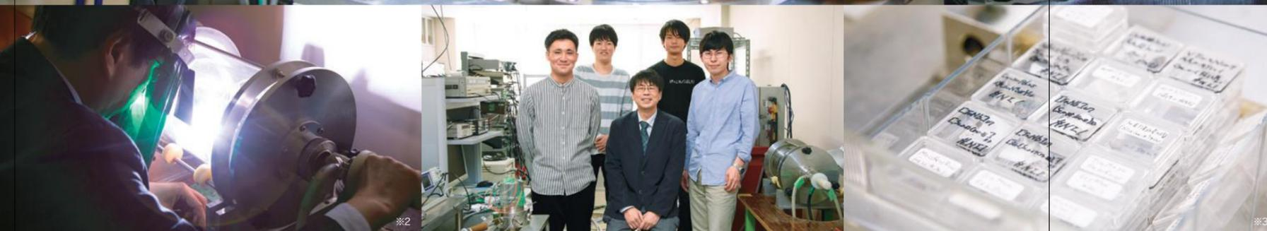
※1 合成した試料をヘリウムガスを用いた装置でマイナス270℃まで冷却。 ※2 超伝導体のもととなる試料の合成をアーク溶解炉で行っている様子。 ※3 超伝導体の候補物質を探すために、膨大な数の試料を合成。
