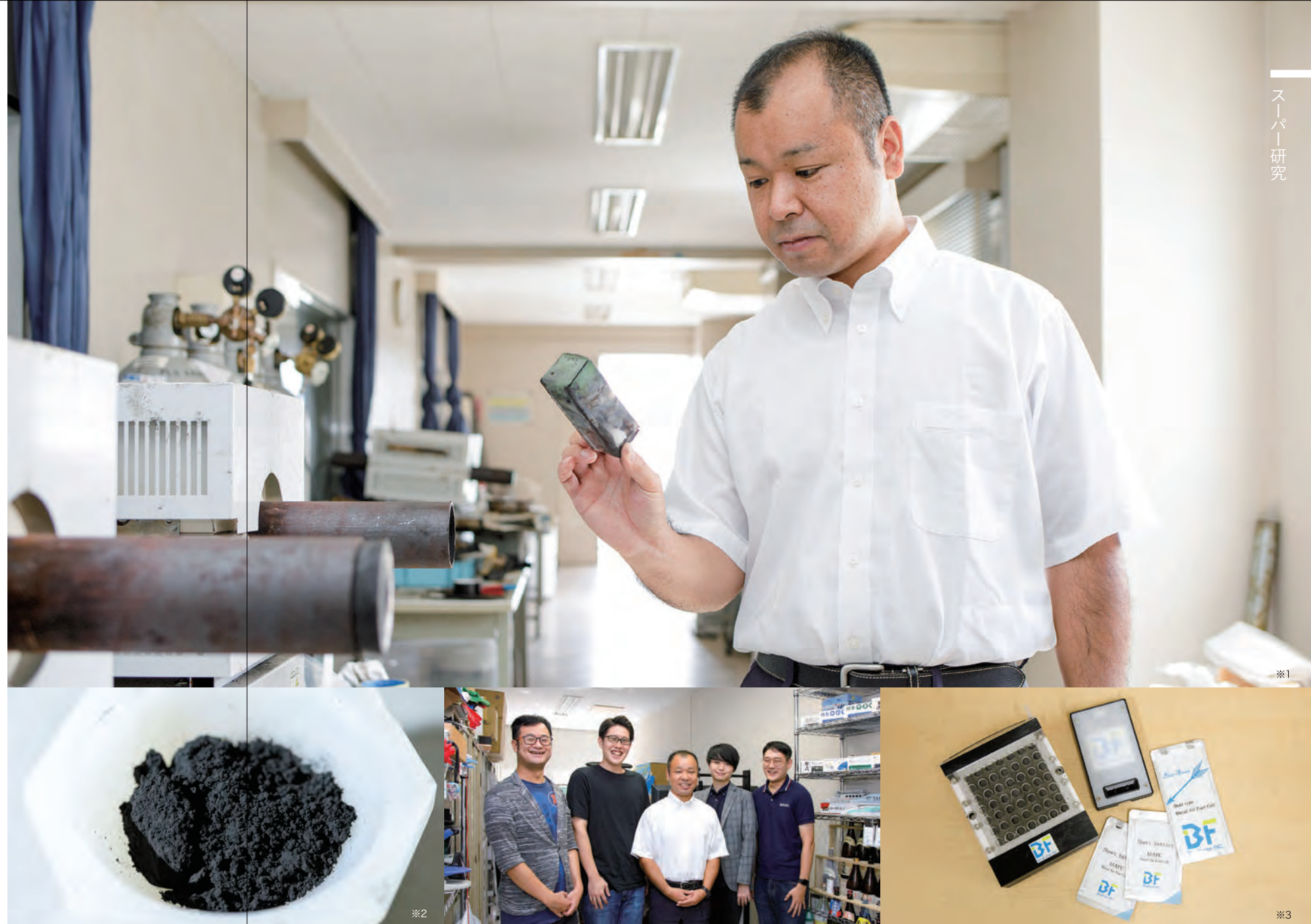
※1 管状炉で焼酎かすを賦活化し、仕上がりをチェックする田島教授 ※2 焼酎かすでつくったパウダー状の活性炭 ※3 「株式会社BlueForce」と開発した金属空気燃料電池と電気二重層キャパシタ
