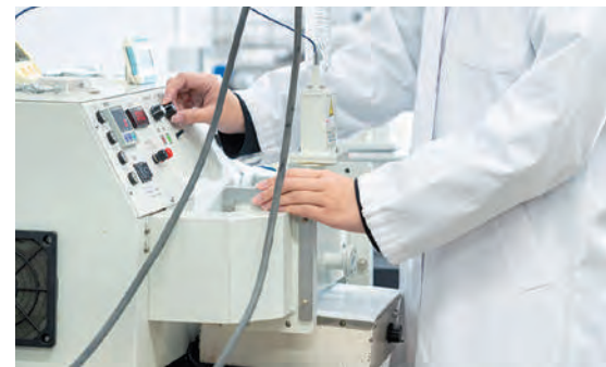
マイクロ反応装置を使ってマイクロ波の照射量や時間を設定し、従来の加熱法に比べてどのくらい効率化できるかを調べます。
